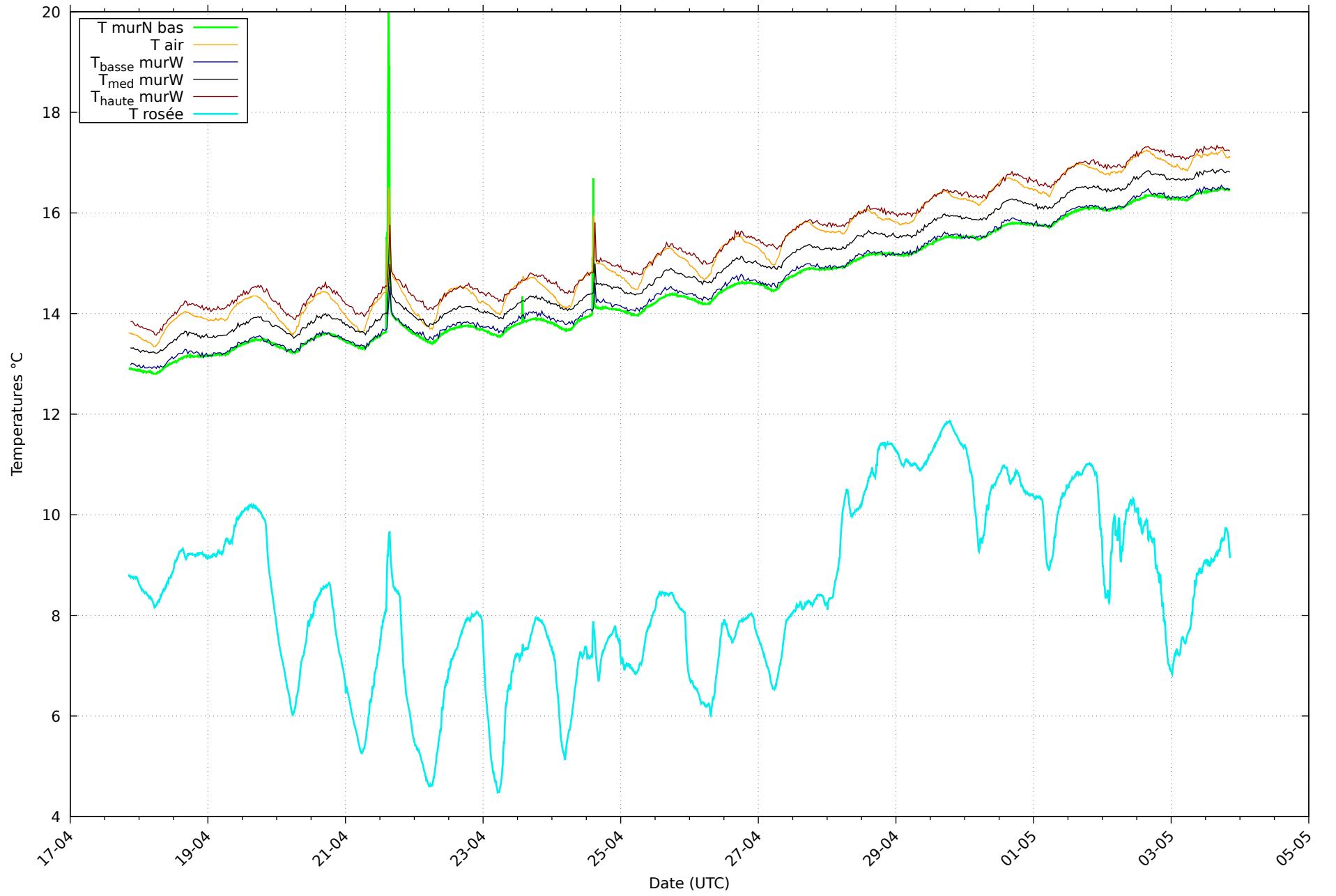
Mur ouest au 03/05/2026
