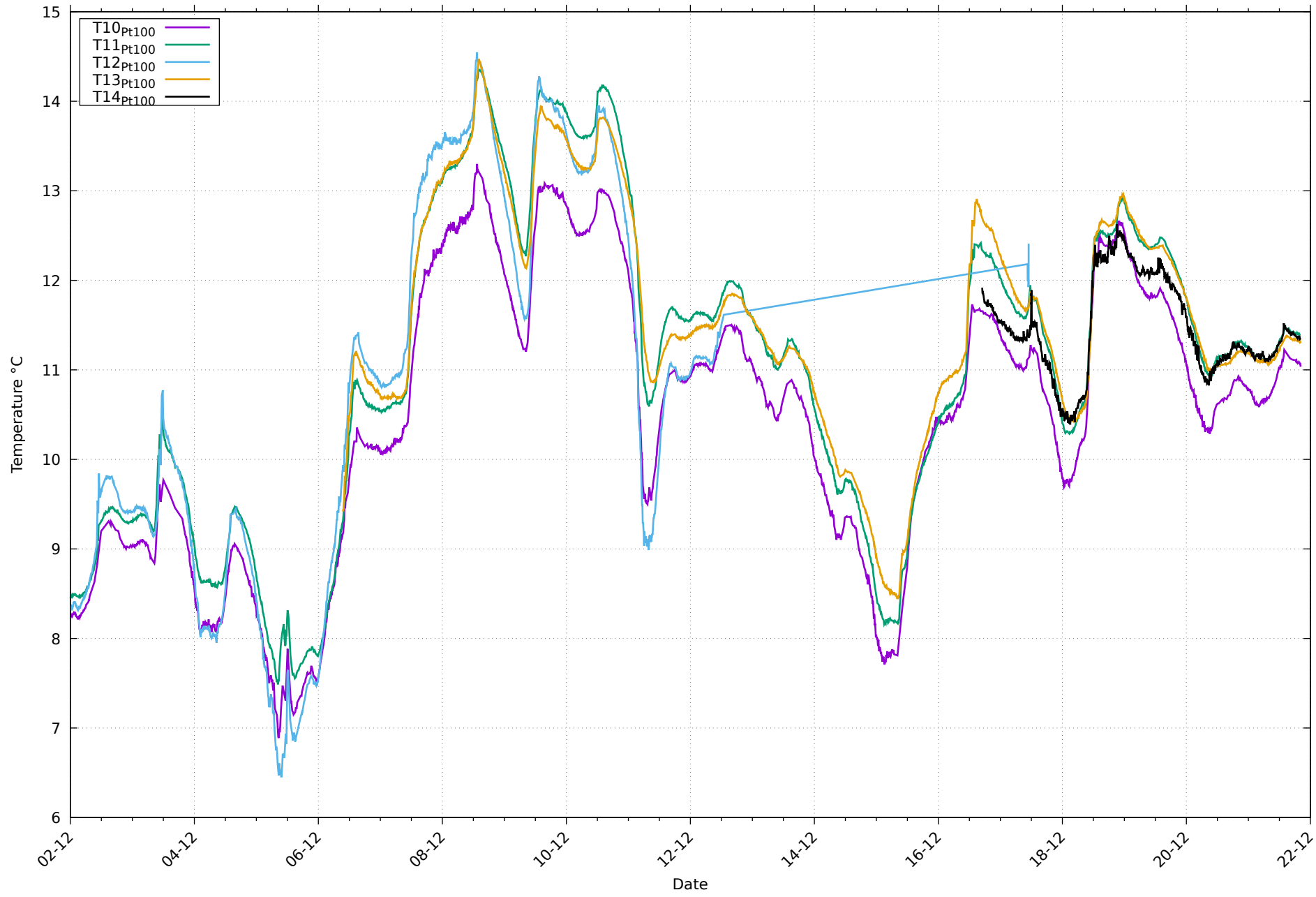
Températures de paroi Pt100 au 21/12/2025
