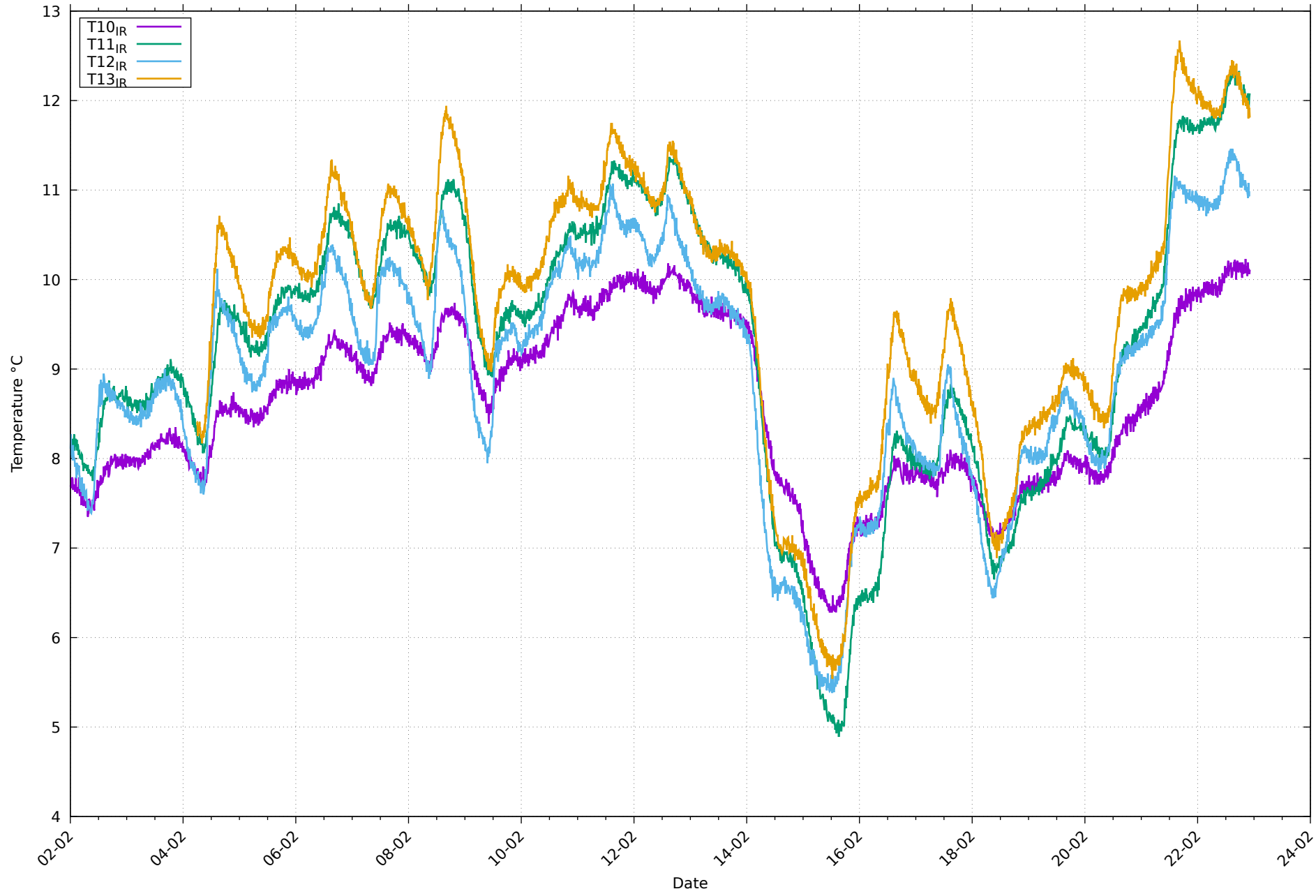
Températures de paroi IR au 22/02/2026
