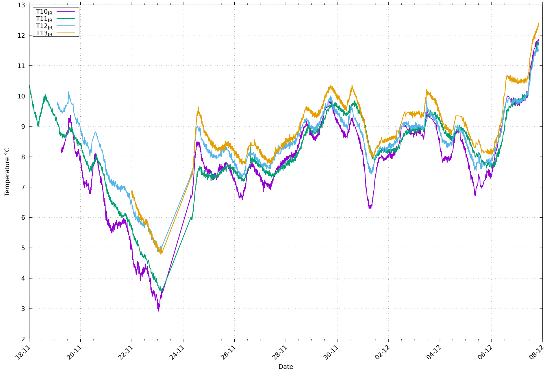
Températures de paroi IR au 07/12/2025
